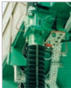
Werkbild: MT Aerospace AG Montagehubvorrichtung mit Faltenbalgabdeckung für ca. 9 m Hub.
