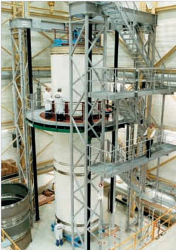
Werkbild: MT Aerospace AG Montagehubvorrichtung mit Faltenbalgabdeckung für ca. 9 m Hub.
