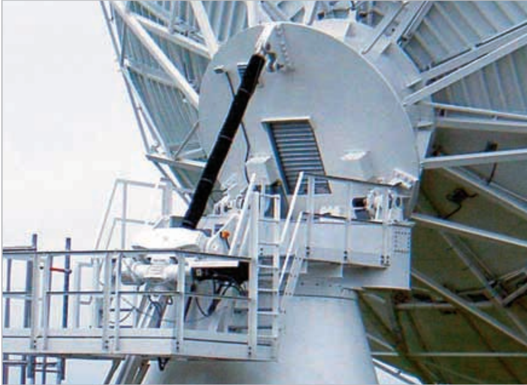
Hochleistungs-Spindelhubelement HSE, Bauart 1, Sonderausführung, für Elevationsbewegung 0° bis 90° einer 11,1 m Antenne
