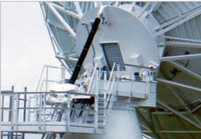
Hochleistungs-Spindelhubelemente HSE Sonderausführung für Elevationsbewe- gung 0° bis 90° einer 11,1 m Antenne
