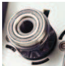
wysokowartościowe okapturzone łożysko oraz panewka ślizgowa.
